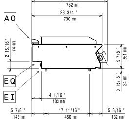
Electrical inlet (power) Equipotential screw
